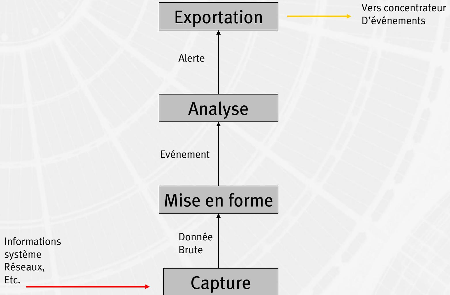
▶ Système de détection d'intrusions: type de sonde
